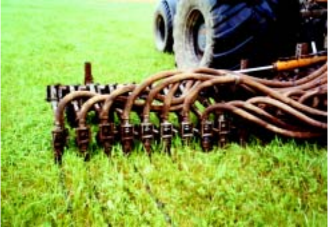
Gülleausbringung mit Schlitzgerät im Grünland zur Minderung des Abschwemmungs- und Auswaschungsrisikos
